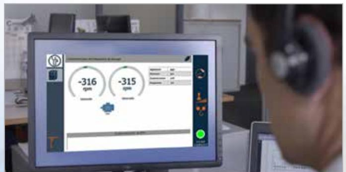
> La connexion à distance permet au technicien d'accéder à l'écran de contrôle du grutier pour réaliser un diagnostic et un dépannage en temps réel.
