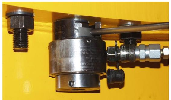
Zur Verwendung dieser Ausrüstung siehe Wartungsabschnitt in der Betriebsanleitung Ihres Krans, in dem die allgemeinen Regeln zum Festziehen von Drehkranzschraubbolzen genau angegeben sind.
