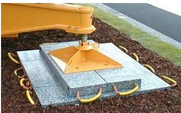
Um die zu benutzenden Abstuetzplatten zu bestimmen, müssen die max. Reaktionskraft unter der Abstuetzung Ihres Krans (vom Hersteller angegeben) **und der max. zulässige Bodendruck unter der Maschine berücksichtigt werden.**
