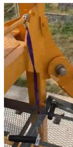
Ce système verrouillable prévient les risques de chute d'axes lors du démontage de la grue
