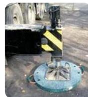
Afin de déterminer le type de plaque d'appui, tenez compte de la réaction maximale sous l'appui de votre grue (indiquée par le constructeur) ainsi que de la pression maximale admissible du sol où la grue sera érigée.
