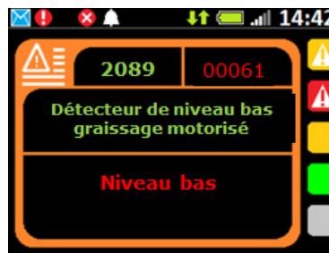
Aide à la maintenance de la grue
