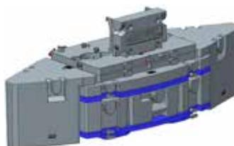
Verschiedenste Gegengewichtskonfigurationen erlauben optimale Transporteigenschaften, beginnend bei 1t Gegengewicht am Kran montiert, über optimale Taxi-Konfigurationen für 12 t / Achse bis hin zu 16,5 t / Achse.
