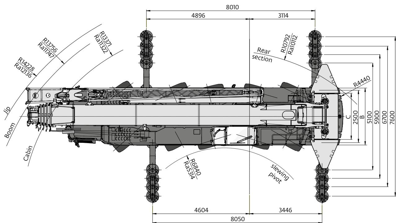
*Ra = Radius all wheels steered • Radius allradgelenkt • Rayon toutes les roues directrices • Radio de giro con todas las ruedas giradas • Raggio di curva con tutte le ruote sterzate
