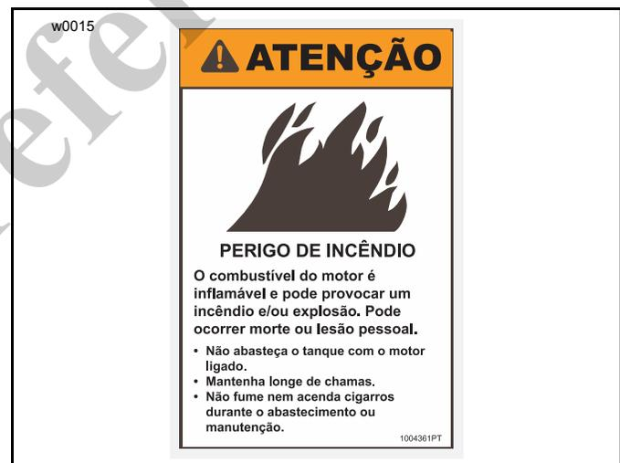
Ao encher o tanque de combustível, mantenha o bico da mangueira sob controle. Não deixe derramar combustível. Limpe o combustível derramado imediatamente. Descarte corretamente os materiais de limpeza.
