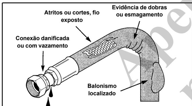
**Inspeção atentamente as mangueiras. Não use as mãos desprotegidas para verificar se há vazamentos. Aperte todas as conexões ao torque recomendado. Substitua se encontrar o seguinte:**
