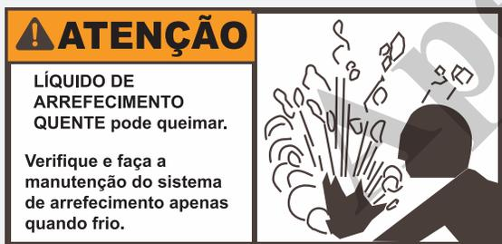
Para garantir o máximo de proteção ao sistema de arrefecimento do motor, adicione um fluido antioxidante no reservatório do radiador. Quando o motor estiver frio, retire a tampa do radiador e derrame o antioxidante no reservatório do radiador, de acordo com as instruções do fabricante.
