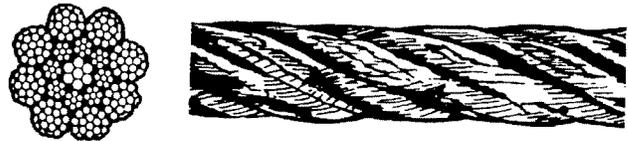
El cable desgastado, el cual usualmente se manifiesta por puntos aplastados en los alambres exteriores como se muestra en la ilustración, no puede usarse de modo seguro cuando resta menos de dos tercios del grosor del alambre exterior.
