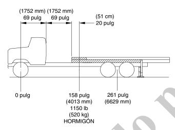
8. Determine los pesos de eje añadidos por el contrapeso usando el mismo método utilizado previamente. Determine el punto central del contrapeso para determinar en dónde actúa el peso. Si el contrapeso tiene forma irregular, calcule el punto central y peso de cada pieza con forma regular. Los pesos colocados delante del eje delantero requieren el uso de una distancia negativa (-) en los cálculos.
