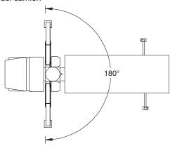
Antes de llevar a cabo operaciones con la pluma, extienda ambos estabilizadores hasta quitar el peso del chasis de las ruedas del camión. Nivele la grúa en sentido lateral. Se proporciona un indicador de nivel en cada puesto de control. Después extienda y baje los estabilizadores para nivelar la grúa en sentido longitudinal. Nuevamente consulte el indicador de nivel para asegurar que la grúa esté debidamente nivelada. Siempre mantenga las cargas lo más cerca posible al suelo.
