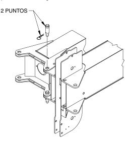
5. Con el plumín fijado por pasador a la cabeza de poleas, gire el plumín para colocarlo paralelo a la pluma e instale el pasador que impide que gire (este pasador está soldado a una cadena en el extremo del plumín).
