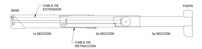
Un cilindro alimentado por varilla y de efecto doble fijado a las secciones 1a y 2a soporta e impulsa la 2a sección de la pluma. Los cables de extensión se fijan al extremo de la base de la 1a sección de la pluma, se enhebran alrededor de las poleas fijadas al cilindro y se fijan al extremo de la base de la 3a sección, proveyendo así soporte y la función de extensión a la 3a sección de la pluma. Los cables de retracción se fijan al extremo de la punta de la 1a sección de
