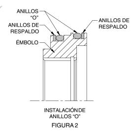
9. Si corresponde, retire el 2o émbolo (36) de la caja del freno (15), inspeccione los anillos "O" (37 y 38) y los anillos de respaldo (39 y 40) en busca de daños. Sustitúyalos de ser necesario. (Vea la Fig. 2) Inspeccione el cojinete (41) de la caja del freno (15) y sustitúyalo de ser necesario.
