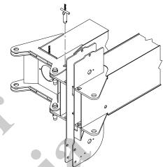
6. Retraiga la pluma lentamente hasta que las orejetas del plumín se encuentren dentro de 0.50 pulg (13 mm) de los conjuntos de orejetas de la primera sección. Observe la alineación vertical de las orejetas del plumín y de los conjuntos de orejetas y añada o retire suplementos hasta que el plumín quede soportado por sus orejetas. El plumín típicamente reposa únicamente sobre el soporte superior.
