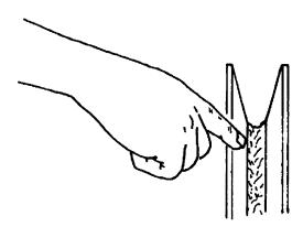
Inspeccione cada 50 horas o semanalmente la punta de la pluma y poleas del aparejo de gancho para determinar si funcionan correctamente, presentan desgaste excesivo o daños. Las poleas desgastadas, dañadas y/o inutilizables pueden acelerar el deterioro del cable.
