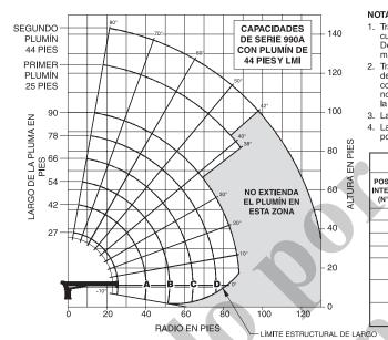
1. Trabaje con el plumín observando las limitaciones de radio cuando la pluma principal esté completamente extendida. De ser necesario, aumente el ángulo de la pluma para mantener el radio de trabajo de la carga.
