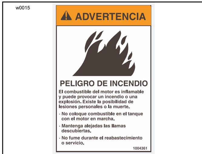
Mantenga controlada la boquilla de la manguera cuando llene el tanque de combustible. No permita que el combustible se derrame. Limpie inmediatamente el combustible derramado. Deseche de manera apropiada los materiales de limpieza.
