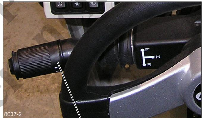
Palanca selectora de sentido de marcha (típica)
