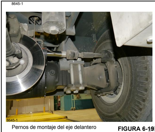
Pernos de montaje del eje delantero
