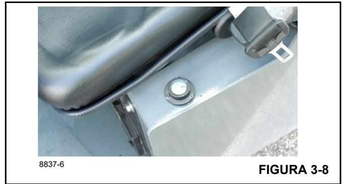
**NOTA:** A norma ASME B30.5 especifica que é necessário reduzir as capacidades permitidas se o guindaste não estiver nivelado dentro de 1% da inclinação. Portanto, seja a elevação feita sobre rodas ou estabilizadores, é essencial que o guindaste fique nivelado dentro de 1% do grau. A exatidão do nível de bolha do guindaste está calibrada dentro de 1% do grau.
