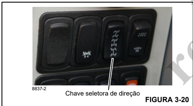
Antes de selecionar um modo de direção diferente, todos os pneus devem estar alinhados em uma posição reta para a frente. Se não estiverem, o direcionamento pode não ser indexado corretamente. Se isso ocorrer, siga as instruções de procedimentos de indexação fornecidas posteriormente nesta seção.
