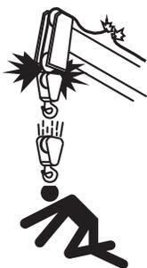
Para evitar morte e ferimentos graves, mantenha os dispositivos de manuseio de carga afastados da ponta do braço/lança ao estender ou abaixar a lança e ao realizar um içamento.
