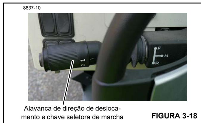
Alavanca de direção de deslocamento e chave seletora de marcha
