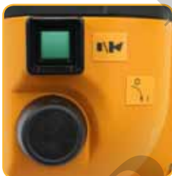
Grüne Starttaste und Schlüsselschalter
