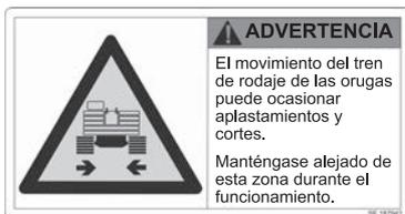
Advertencia de riesgo de aplastamiento o de cortaduras debido al movimiento del tren de rodaje de las orugas. Manténgase alejado de la zona de peligro durante el funcionamiento.
