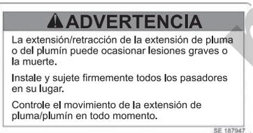
Advertencia de lesiones graves o mortales debido a la extensión y retracción de la pluma de extremo o del plumín auxiliar.
