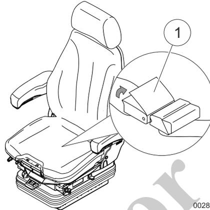
Fig. 27 Apertura del cinturón de seguridad
