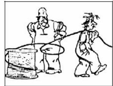
En ninguna circunstancia, sin embargo, debe tirarse del cable lateralmente de la bobina o del carrete, porque se introduce torsión en el cable en cada vuelta que se desenrolla. Cada torcedura del cable cambia el largo del sesgo de las trenzas y del cable, y además la relación entre las longitudes de los elementos del cable, y las distribuciones de carga en el cable.
