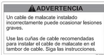
Advertencia de lesiones graves debido a un cable instalado incorrectamente.
