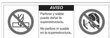
Aviso concerniente al daño potencial a la carrocería superior debido a perforaciones y soldaduras.
