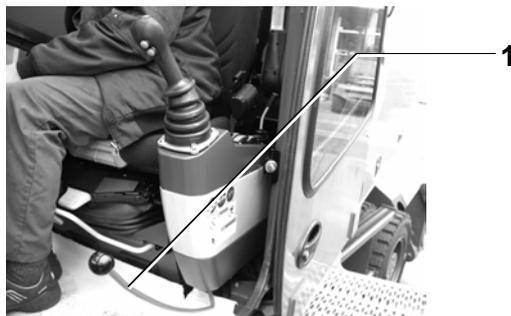
Fig. 71 Palanca de seguridad liberada (empujada hacia adelante)
