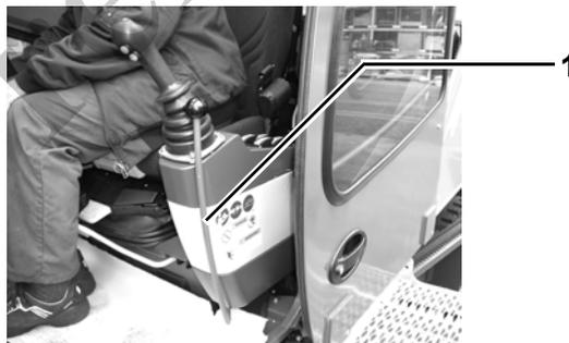
Fig. 70 Palanca de seguridad activada (tirada hacia atrás)
