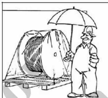
Los cables deben almacenarse en un sitio cubierto, limpio, fresco y seco. Debe evitarse que queden en contacto con el suelo, almacenándolos en estanterías, por ejemplo.
