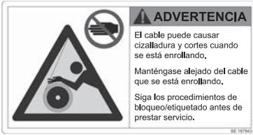
Riesgo de cortadura o pérdida de extremidades debido a cable enrollándose. Manténgase alejado del cable cuando esté enrollándose.
