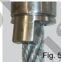
**Dispositivo de bloqueo de rotación** (punta) en la cola de la terminación de extremo para impedir que los cables resistentes y no resistentes a la rotación se retuerzan.
