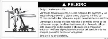
Advertencia de lesiones mortales debido a una descarga eléctrica. Mantenga las distancias de seguridad necesarias.
