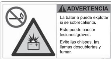
Advertencia de riesgo de explosión de la batería debido a sobrecalentamiento.
