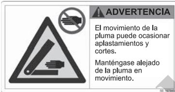
Advertencia de riesgo de aplastamiento o de cortaduras debido al movimiento de la pluma. Manténgase alejado de la zona de peligro.
