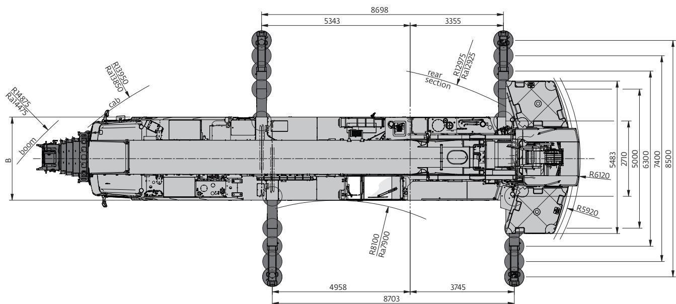
*Ra = Radius all wheels steered. • Radius allradgelenkt. • Rayon toutes les roues directrices. • Radio de giro con todas las ruedas giradas. • Raggio di curva con tutte le ruote sterzate. • Радиус поворота при управлении всеми колесами.*
