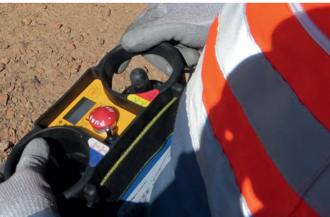
Funksteuerung mit Standard – Potain Display zur Bedienerunterstützung
