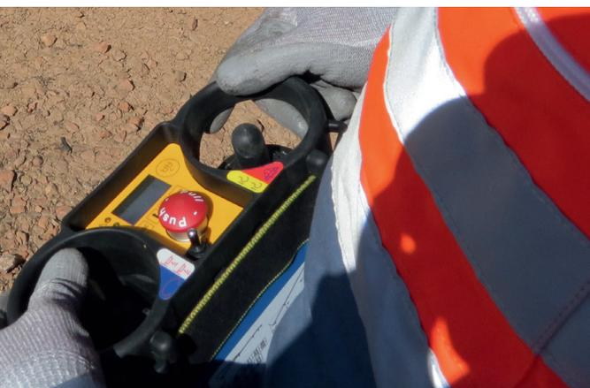
Radiocommande avec indicateurs d'aide à la conduite standard Potain
