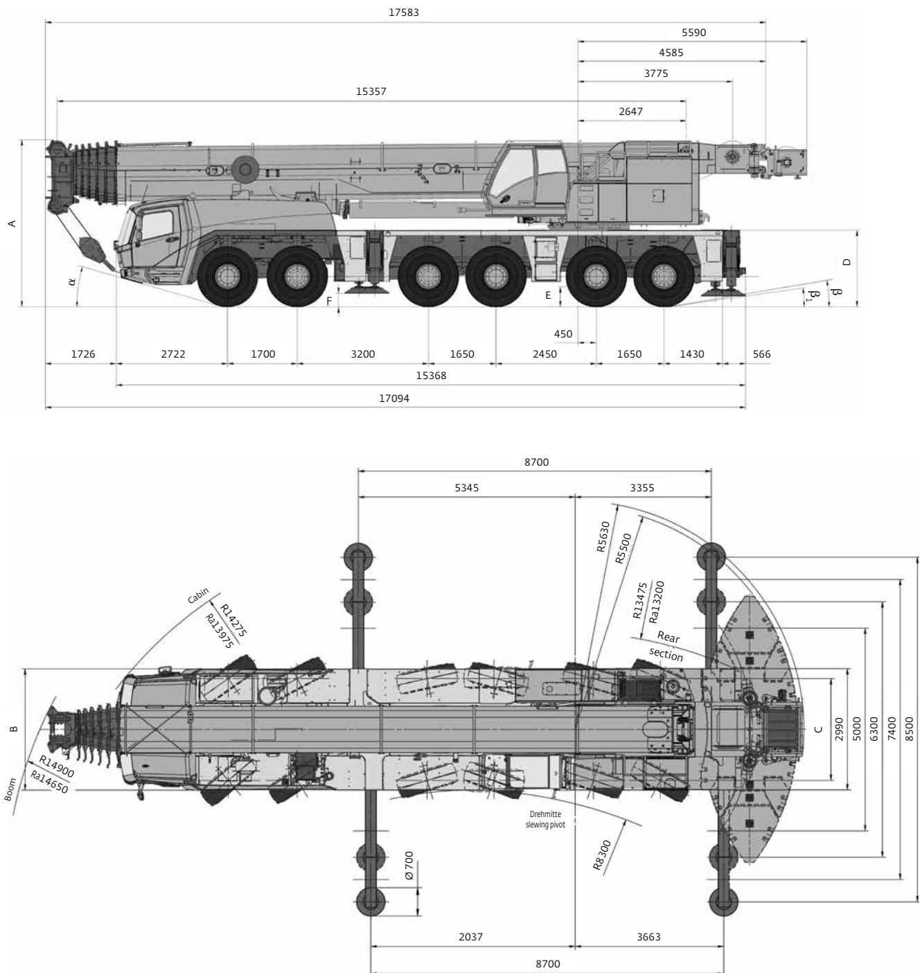
*R<sub>a</sub> = Radius all wheels steered • Radius allradgelenkt • Rayon toutes les roues directrices • Radio de giro con todas las ruedas giradas • Raggio di curva con tutte le ruote sterzate • Paduyc novopoma npu управлении всеми колесами*
