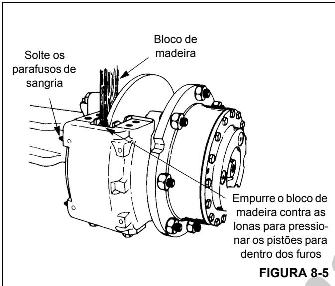
3. Use um pedaço de madeira apoiado nas lonas como uma alavanca para empurrar os pistões completamente para dentro da carcaça. Aperte os parafusos de sangria (Figura 8-5).
