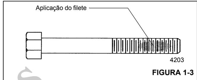
1. Aplique um filete perpendicular à rosca, cobrindo vários sulcos, no local aproximado do engate das roscas (Figura 1-3).
