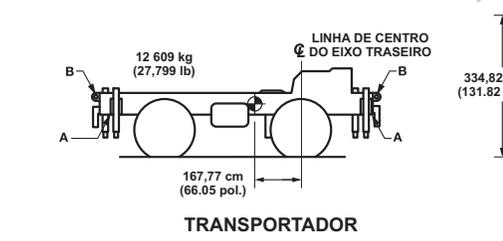
1. A ELEVAÇÃO DO GUINDASTE INTEIRO OU DE GRANDES CONJUNTOS PODE SER EXECUTADA UTILIZANDO-SE CONEXÕES ESPECÍFICAS INDICADAS NA TABELA ACIMA. É PROIBIDO O USO DAS CONEXÕES PARA FINS DIFERENTES DOS DESIGNADOS NA TABELA. AS CAPACIDADES DAS CONEXÕES SÃO AS CARGAS MÁXIMAS PERMISSÍVEIS POR CONEXÃO INDIVIDUAL.
