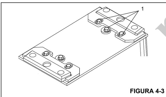
3. Na parte frontal superior da seção da base, remova os dois parafusos que fixam cada placa batente e remova essas placas.
