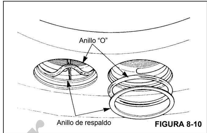
11. Inspeccione las acanaladuras para anillos en la caja en busca de rasguños y de oxidación. Quite los rasguños leves y la oxidación con un trapo de esmeril. Reemplace la caja si hay rasguños grandes o una cantidad abundante de oxidación. Consulte el tema Inspección - Piezas de las pinzas.
