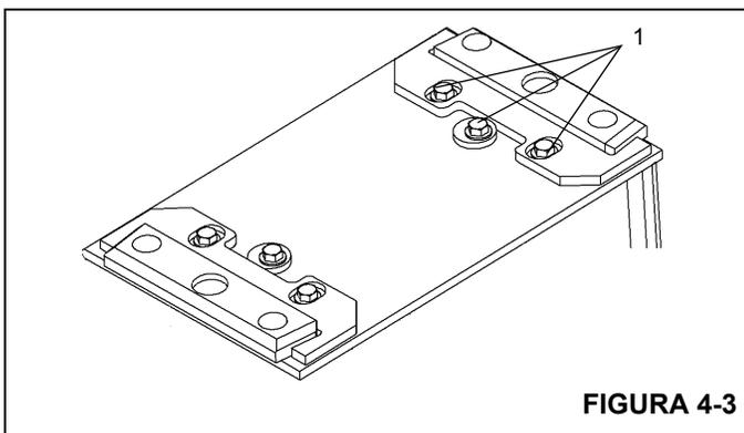
3. En la parte superior delantera de la sección de base, quite los dos pernos que fijan cada placa de contragolpe y quite las placas.
