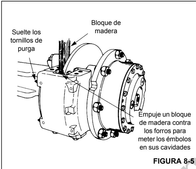
3. Utilice un pedazo de madera como palanca contra los forros para empujar los émbolos hasta meterlos completamente en la caja. Apriete los tornillos de purga (Figura 8-5).
