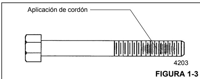
1. Aplique un cordón en sentido perpendicular a las roscas, de un ancho equivalente al de varias roscas, en la zona aproximada de engrane de las roscas (Figura 1-3).
