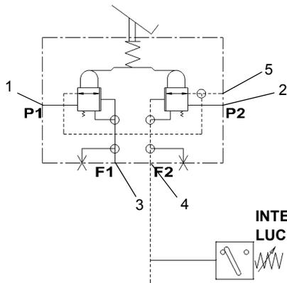
Diagrama esquemático hidráulico de válvulas
