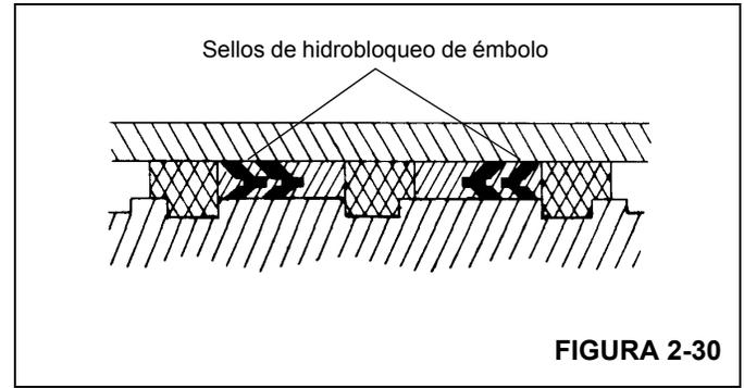
7. Instale los sellos de hidrobloqueo de repuesto en la parte exterior del émbolo. Asegúrese de que las partes en V de los dos sellos de hidrobloqueo apunten la una hacia la otra (Figura 2-30).
