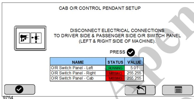
3. Quando solicitado, desconecte as conexões elétricas para os painéis de controle do estabilizador do lado do condutor e do passageiro. Pressione a tecla de função OK
