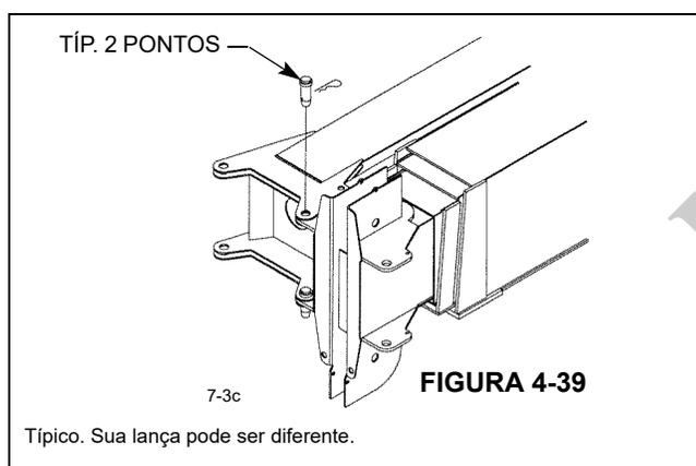
3. Com o jib preso à cabeça da polia, gire o jib paralelo à lança usando um cabo de apoio. Observe o alinhamento do conjunto de montagem do jib traseiro e do suporte de retração traseiro do jib (Figura 4-40). Se necessário, ajuste a posição vertical do suporte de montagem do jib traseiro na seção da lança da base da seguinte forma:
