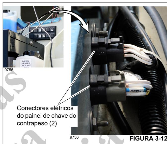
O painel de controle do contrapeso do lado direito (lado do passageiro) está localizado na tampa da válvula atrás do tanque hidráulico (Figura 3-13). A tampa da válvula deve ser removida para acessar e desconectar o painel de controle do contrapeso.
