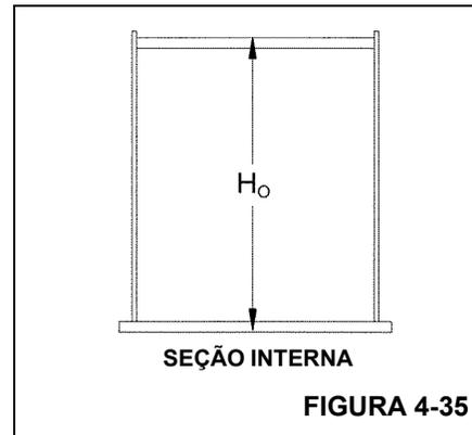
4. Subtraia a largura externa ( $W_o$ ) da seção interna e a espessura das duas placas ( $t_{wp}$ ) da largura interna ( $W_i$ ) da seção externa. Adicione calços conforme necessário (cada calço tem espessura de 0,7 mm [0.03 pol.]) para apertar as placas, de forma que haja uma folga de 0.00 a 0.06 pol. entre as placas de desgaste inferiores da traseira da lança interna e a parte mais estreita da lança externa quando os calços estiverem instalados.
