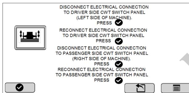
4. Confirme que as conexões elétricas apropriadas foram desconectadas e siga as instruções exibidas na tela.
