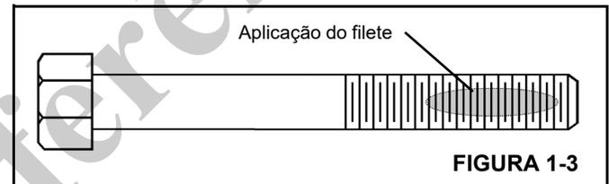
1. Aplique um filete cobrindo várias roscas, na área aproximada do contato roscado (Figura 1-3).
