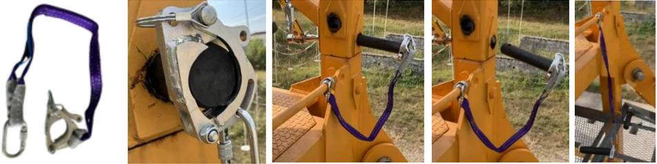
Dieses arretierbare System verhindert die Gefahr, dass bei der Demontage des Krans Bolzen herunterfallen.
