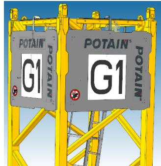
1 kit complet se compose du kit anti-intrusion, d'une trappe au choix et du cadenas.
