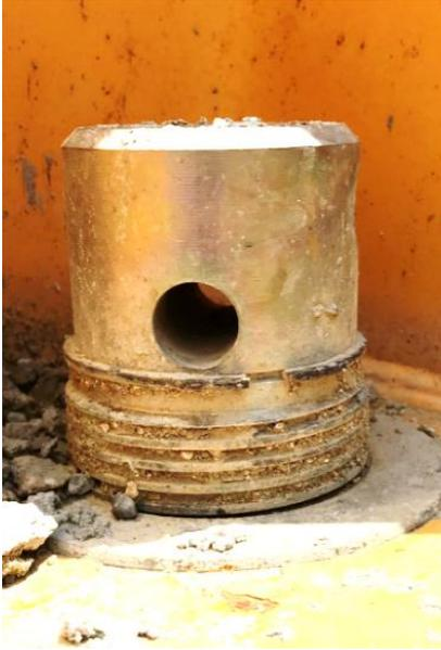
Ce soufflet de protection préserve le filetage de la poussière et du béton.
