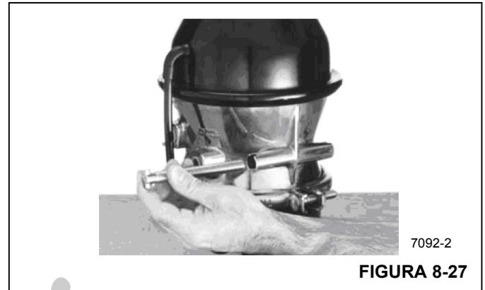
4. Inserte el perno soltador en el agujero central de la cabeza. Verifique que el extremo formado del perno haya penetrado en el agujero del émbolo que está dentro de la cámara. Continúe insertando el perno hasta que tope (Figura 8-28).
