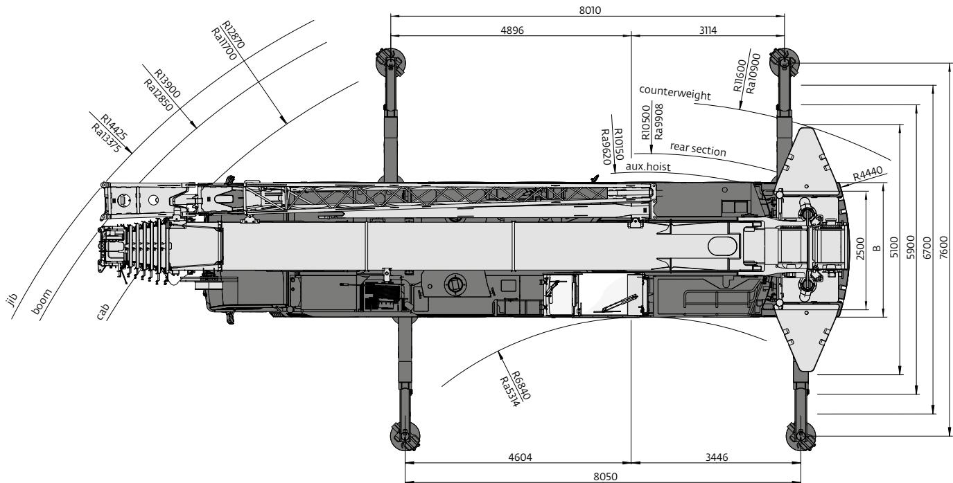
*Ra = Radius all wheels steered. • Radius allradgelenkt. • Rayon toutes les roues directrices. • Radio de giro con todas las ruedas giradas. • Raggio di curva con tutte le ruote sterzate.*
