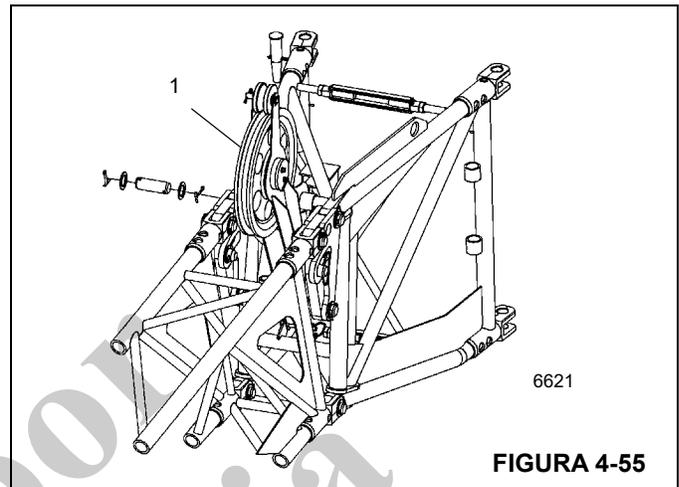
Para evitar que el cable de elevación se arrastre en la pluma principal o en la extensión de celosía durante el funcionamiento con la extensión de celosía o con la extensión de pluma, el cable de elevación se guía por medio de las poleas deflectoras.
