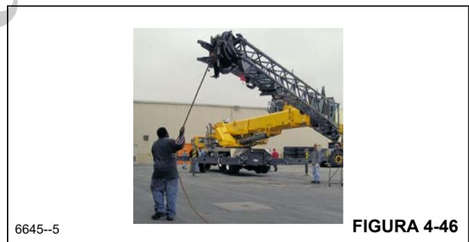
**NOTA:** El paso 8 se realiza con la sección de 7 m (23 pies) almacenada en la pluma. Si se almacenan juntas las secciones de 7 m (23 pies) y de 10.1 m (33 pies), continúe con el paso 10.
