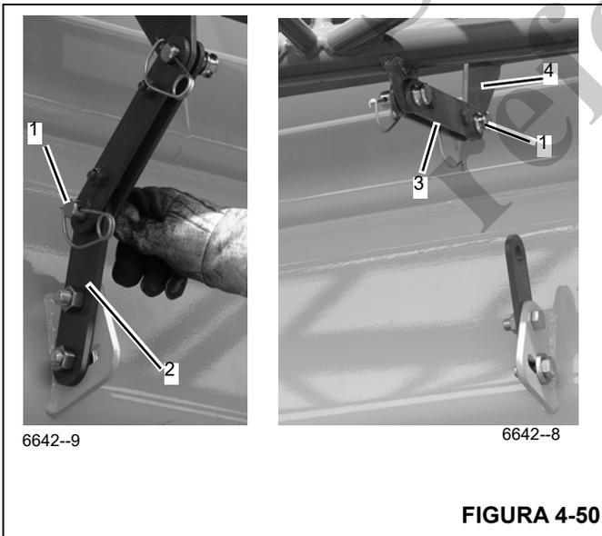
15. Si no se utilizó la sección de plegado doble de 7 m (23 pies), retire el pasador de almacenamiento
