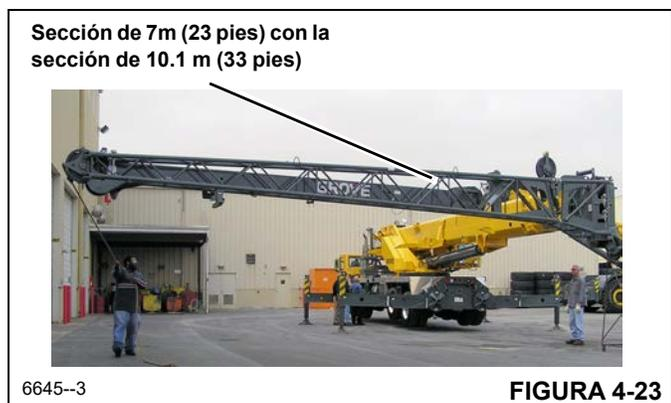
**NOTA:** El paso 17 se realiza con la sección de 7 m (23 pies) almacenada en la pluma.
