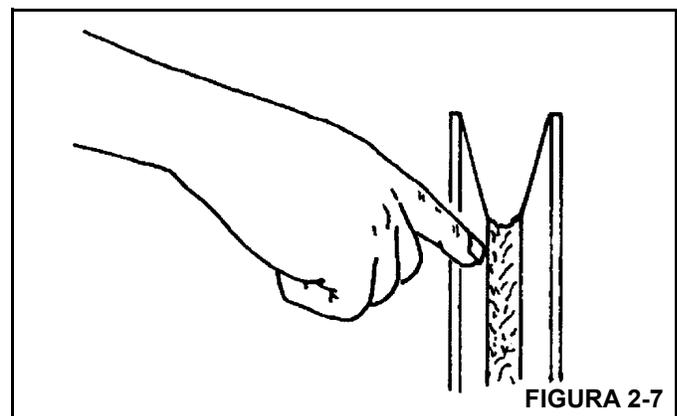
Inspeccione cada 50 horas o semanalmente la punta de la pluma y poleas del aparejo de gancho para determinar si funcionan correctamente, presentan desgaste excesivo o daños. Las poleas desgastadas, dañadas y/o inutilizables pueden acelerar el deterioro del cable.
