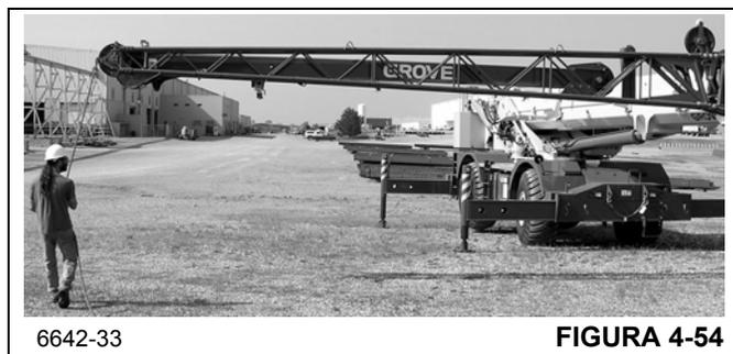
**NOTA:** El paso 9. se realiza con la sección de 7 m (23 pies) almacenada en la pluma. Si se almacenan juntas las secciones de 7 m (23 pies) y de 10.1 m (33 pies), continúe con el paso 10.
