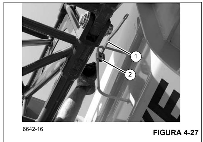
17. Retire el cable guía de la superestructura.
