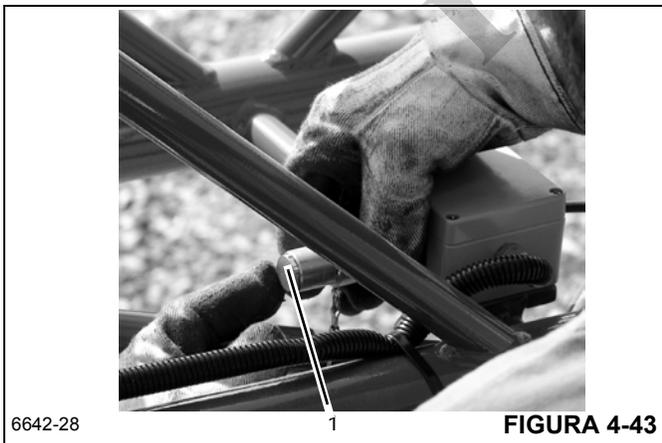
4. Retire la pinza de retención y el pasador de retención de la sección de plegado doble del lado izquierdo (1) (Figura 4-44). Coloque el pasador en el retenedor.
