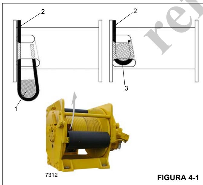
4. Coloque la cuña de anclaje en la ranura del tambor; tire firmemente del extremo suelto (2) del cable para asegurar la cuña.
