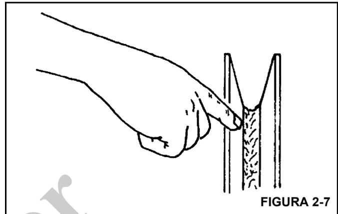
Inspeccione cada 50 horas o semanalmente la punta de la pluma y poleas del aparejo de gancho para determinar si funcionan correctamente, presentan desgaste excesivo o daños. Las poleas desgastadas, dañadas y/o inutilizables pueden acelerar el deterioro del cable.
