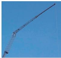
La extensión angulable de celosía y doble pliegue se puede estivar fácilmente en el lateral de la pluma base para transportarla cómodamente. Además, se puede elegir entre una extensión de desviación manual o, de forma opcional, una de desviación hidráulica. Y por si eso fuera poco, se pueden acoplar dos secciones insertadas adicionales con las que la grúa alcanza una altura máxima de la punta al suelo de 72,2 m (237 ft).
