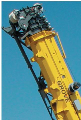
La superestructura incorpora una pluma MEGAFORM de cinco secciones, todas las cuales se pueden extender, que alcanza una altura máxima de la punta al suelo de 45,7 m (150 ft). El sistema TWIN-LOCK de fijación de la pluma proporciona la preselección de los modos de extensión de la misma para fijar correctamente las secciones de la pluma de forma automática.
