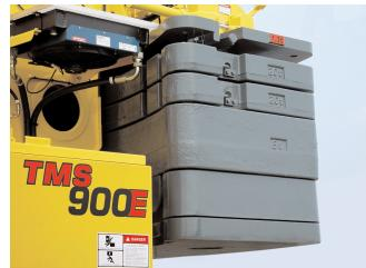
Hasta 14.288 kg (31.500 lbs) de contrapeso se pueden montar y desmontar mecánicamente desde la cabina de la superestructura, lo que facilita enormemente el transporte.
