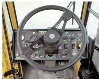
Las funciones de la grúa se controlan a través de un Sistema ECOS (siglas en inglés de Sistema Operativo Electrónico de Grúa) con un motor CAN-BUS. El indicador de momento de carga EKS4 proporciona información detallada para el control de las funciones de la grúa. Un motor diesel ISM 450 controlado electrónicamente aporta potencia más que suficiente tanto dentro como fuera de las obras.
