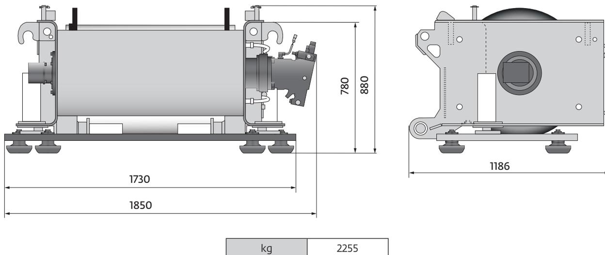
Hose reel • Schlauchtrommel • Enrouleur • Bobina de manguera • Anvolgitubo • Барабан лебедки
