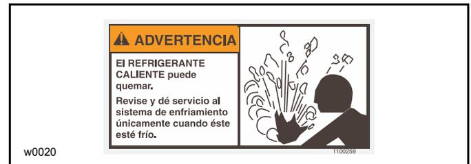
Para lograr una máxima protección del sistema de enfriamiento del motor, agréguele al radiador un inhibidor de corrosión. Cuando esté frío el motor, retire la tapa del radiador y vierta el inhibidor en el depósito del radiador.
