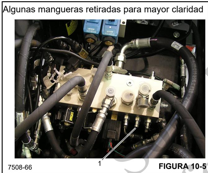
3. Arranque el motor y permita que el aceite hidráulico alcance la temperatura de funcionamiento. Acelere el motor a la velocidad máxima. Gire el volante y coloque las ruedas al ángulo máximo. Continúe girando el volante después de que las ruedas alcancen el ángulo máximo. Lea el manómetro y luego suelte el volante de la dirección.
