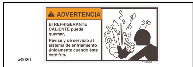
**Nunca** retire la tapa del radiador mientras el sistema de enfriamiento está caliente. Revise el nivel de refrigerante únicamente cuando la temperatura del refrigerante esté baja. El sistema está bajo presión y el refrigerante puede ocasionar quemaduras graves o lesiones en los ojos. Use vestimenta protectora y gafas de seguridad. Siempre gire la tapa lentamente al primer tope y deje que la presión se escape antes de retirar la tapa completamente.
