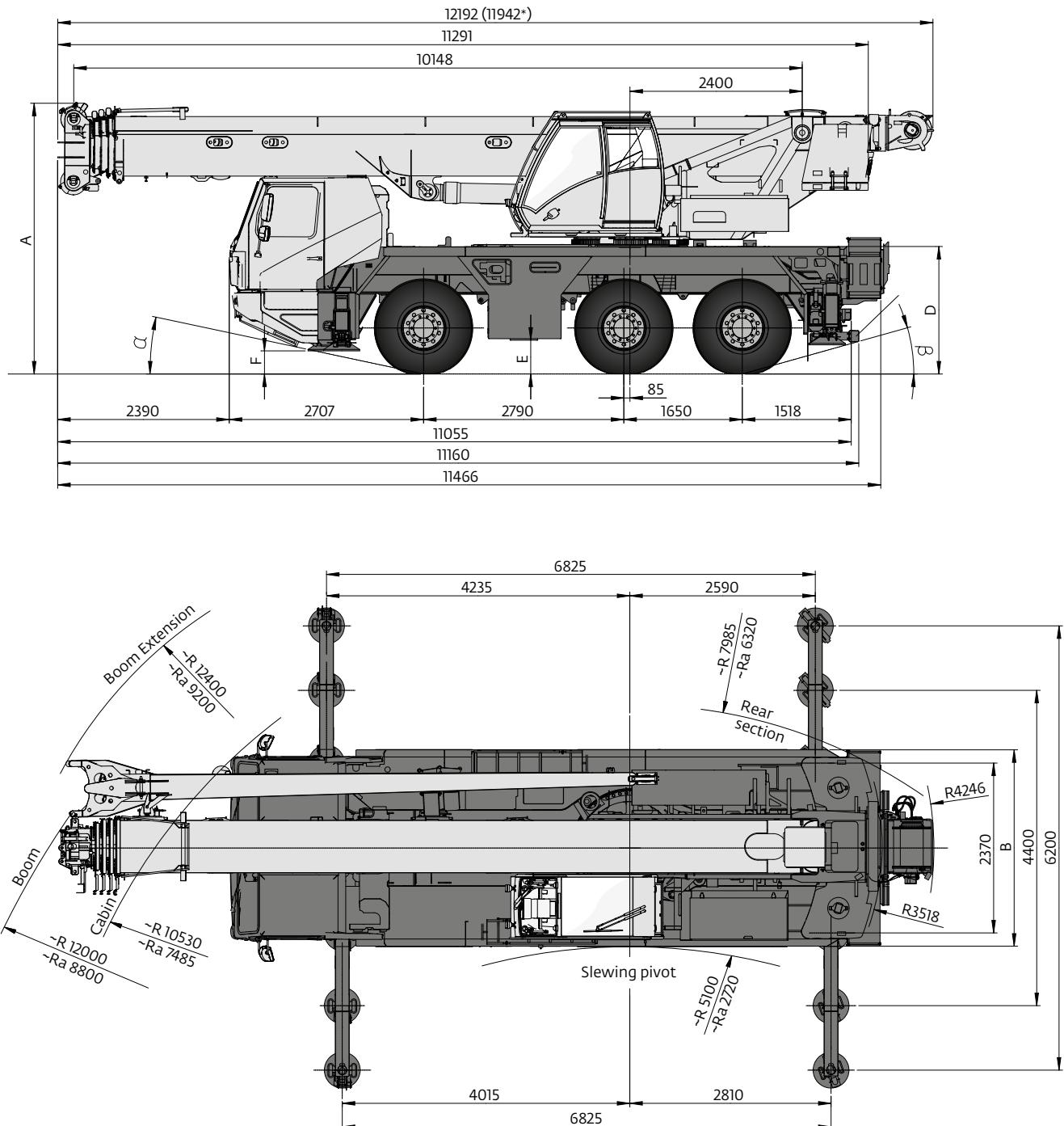
\* with quick release brackets removed • ohne Schnellwechselrahmen • supports avec dépose rapide • sin sistema de desmontaje rápido • senza staffe di sgancio rapido • Быстроразъемное съемное крепление
