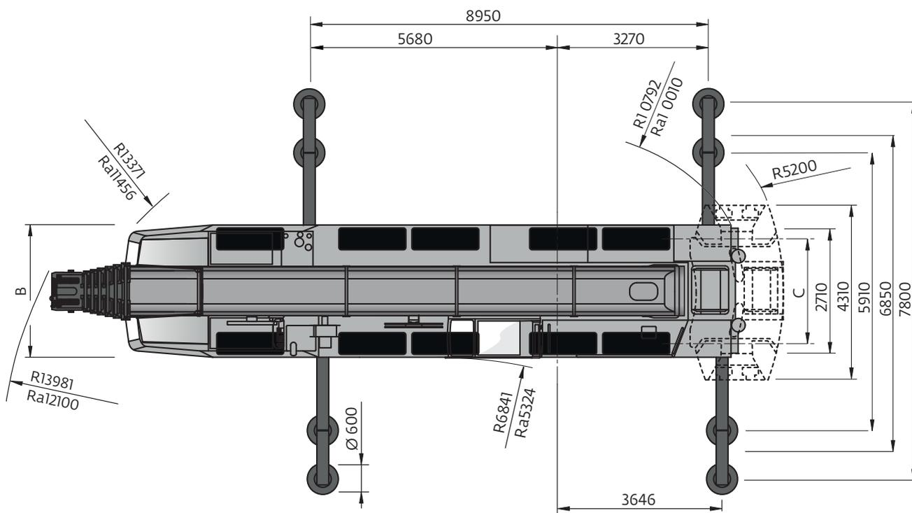
Ra = Radius all wheels steered. • Radius allradgelenkt. • Rayon toutes les roues directrices. • Radio de giro con todas las ruedas giradas. • Raggio di curva con tutte le ruote sterzate.
