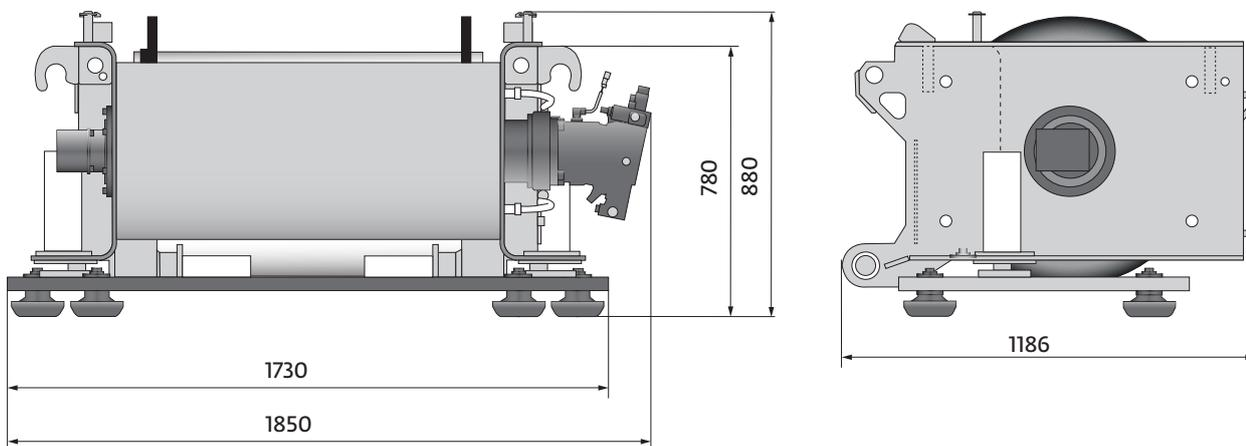
Hose reel • Schlauchtrommel • Enrouleur • Bobina de manguera • Anvolgitubo • Барабан лебедки
