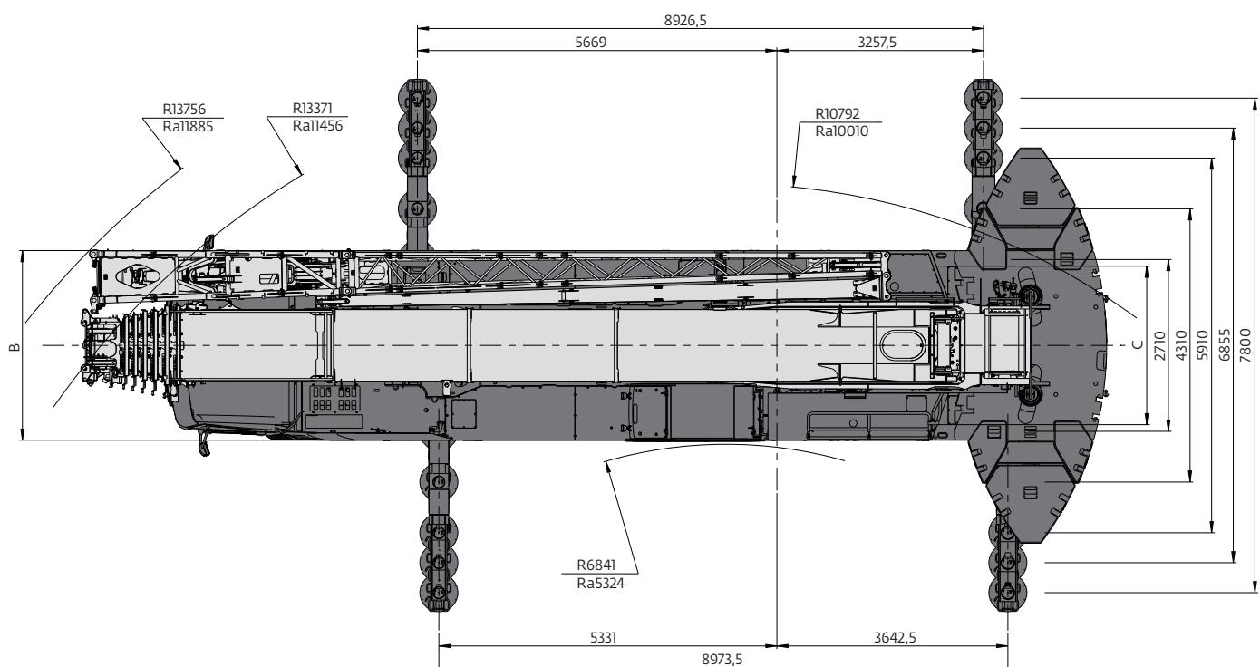
Ra = Radius all wheels steered. • Radius allradgelenkt. • Rayon toutes les roues directrices. • Radio de giro con todas las ruedas giradas. • Raggio di curva con tutte le ruote sterzate.
