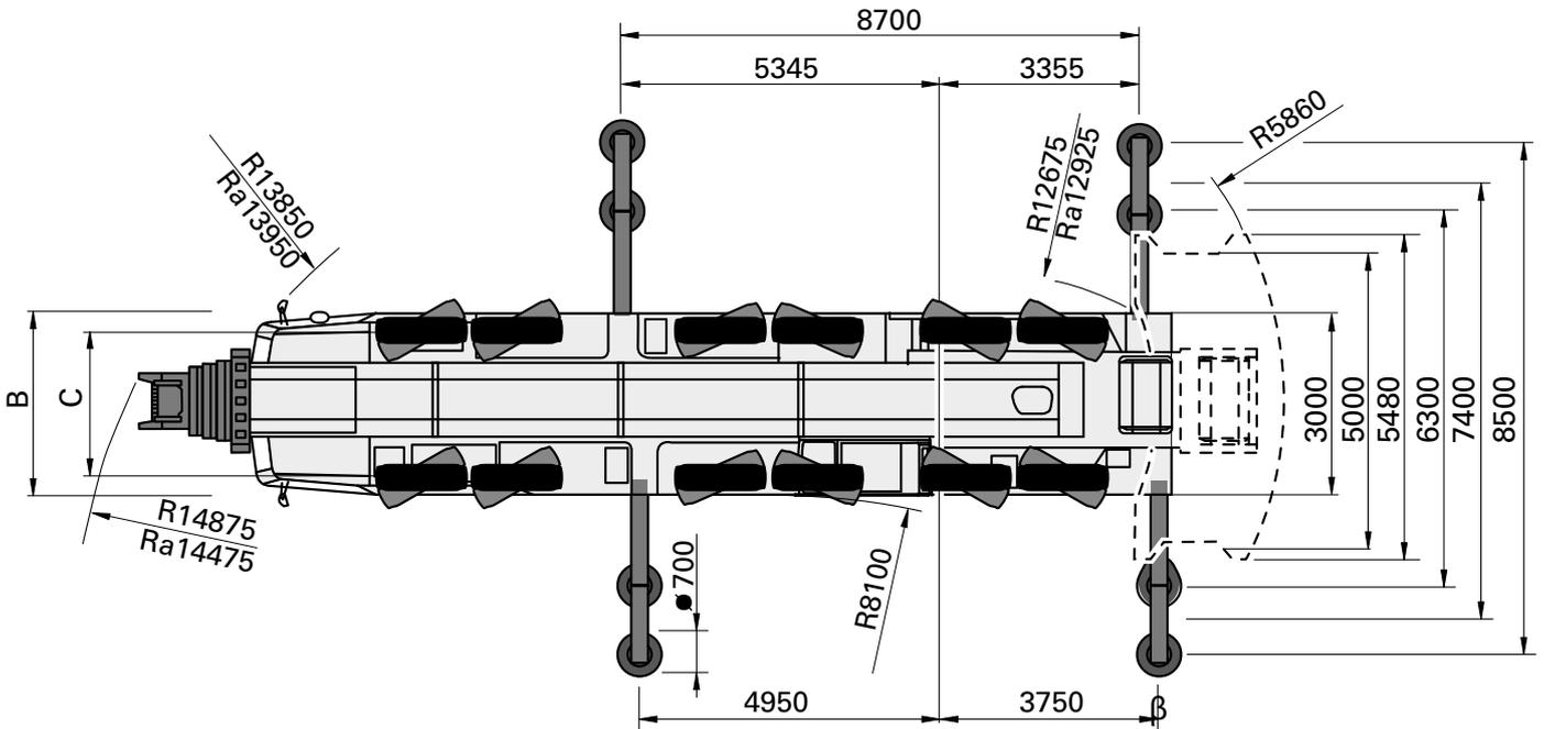
Ra = Radius all wheels steered • Radius allradgelenkt • Rayon toutes les roues directrices • Radio de giro con todas las ruedas giradas • Raggio di curva con tutte le ruote sterzate • Радиус поворота при управлении всеми колесами
