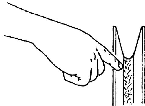
Inspeção a operação correta, desgaste excessivo e danos na extremidade da lança e polias do moitão a cada 50 horas ou semanalmente. Polias sem condições de operar, danifi-
