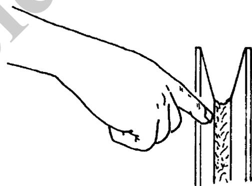
Inspeccione a operação correta, desgaste excessivo e danos na extremidade da lança e polias do moitão a cada 50 horas ou semanalmente. Polias sem condições de operar, danificadas e/ou desgastadas provocam a rápida deterioração do cabo de aço.
