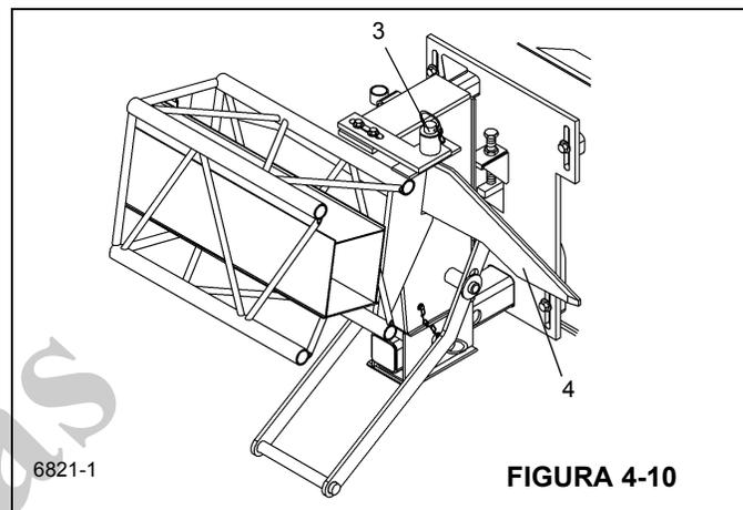
6. Prenda um comprimento do cabo na ponta da extensão da lança para auxiliar na movimentação da extensão da lança no lugar na frente da extremidade da lança.
