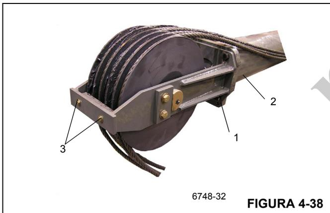
5. Conecte um dispositivo de elevação adequado ao cilindro telescópico. Levante o cilindro telescópico.
