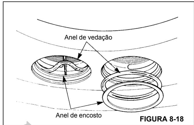
11. Inspeção se há a arranhões e ferrugem nos canais do anel na carcaça. Remova os pequenos arranhões e a ferrugem com uma lixa. Substitua a carcaça se os arranhões forem grandes ou se houver muita ferrugem. Consulte Inspeção - Peças do calíper.
