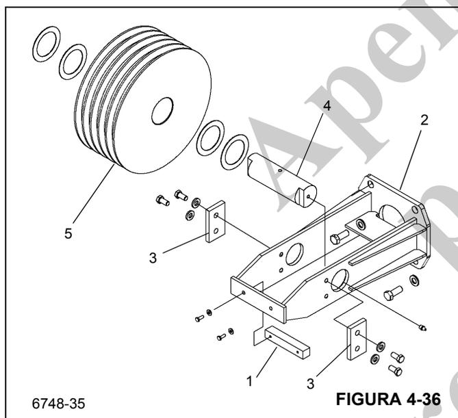
5. Instale o conjunto da polia (Figura 4-36, 5), o eixo (Figura 4-36, 4) e os espaçadores. Instale o eixo com a graxeira voltada para a ESQUERDA e os entalhes para a frente da lança.
