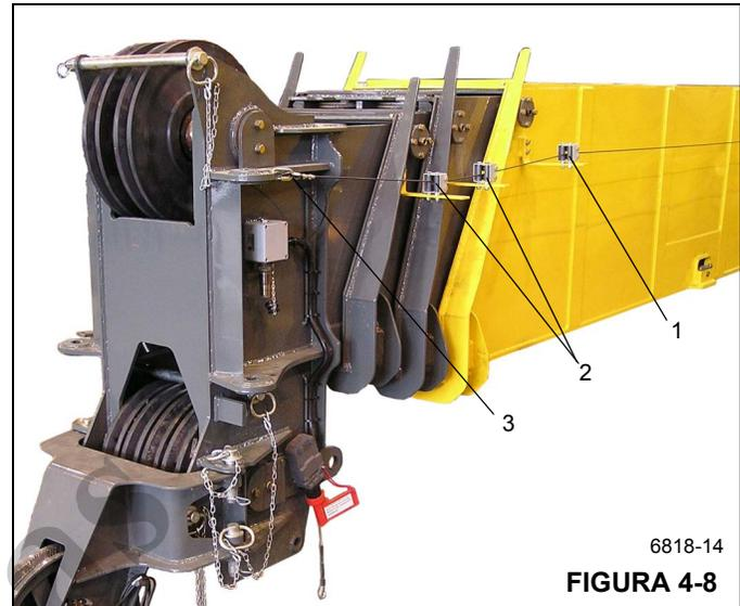
4. Acorrente juntas as seções volante, intermediária externa e intermediária interna. Isso evitará a extensão inadvertida ou inesperada dessas seções durante a desmontagem da lança (Figura 4-9).
