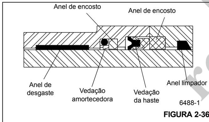
15. Instale o anel de vedação e o anel de encosto na parte externa da cabeça externa do cilindro.
