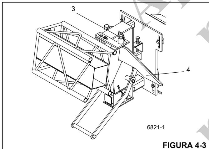
5. Prenda um comprimento do cabo na ponta da extensão da lança para auxiliar na movimentação da extensão da lança no lugar na frente da extremidade da lança.
