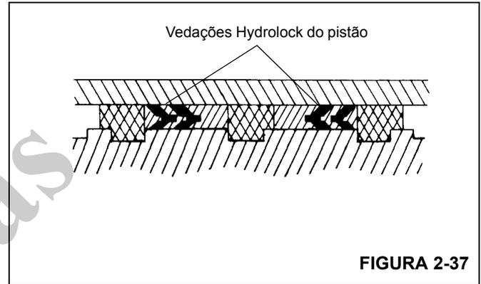
19. Instale as vedações Hydrolock e os anéis de desgaste no pistão (Figura 2-37).
