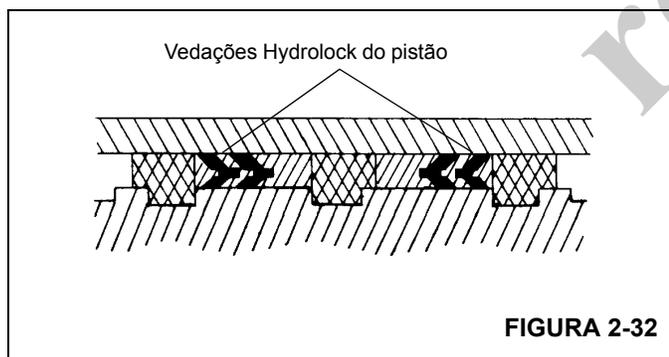
7. Instale as vedações Hydrolock de reposição na parte externa do pistão. Verifique se os dois "vês" nas vedações Hydrolock apontam um para o outro (Figura 2-32).
