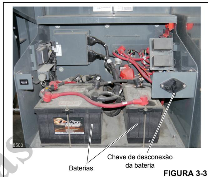
Uma chave de desconexão da bateria está localizada à direita da caixa das baterias (Figura 3-3). Para desconectar as baterias, aguarde dois minutos depois de girar a chave de ignição para Desligada e, então, gire a chave de desconexão da bateria para Desligada. Gire a chave para a posição ON para conectar as baterias.
