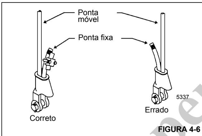
3. Certifique-se de que o lado do cabo móvel com a carga (Figura 4-6) esteja diretamente alinhado com as orelhas do terminal e a direção da tração a que o cabo será submetido. Se o cabo for incorretamente carregado no terminal, sob uma carga, o cabo dobrará conforme sai do terminal e a borda do terminal se desgastará no cabo causando danos ao cabo e falhas eventuais.
