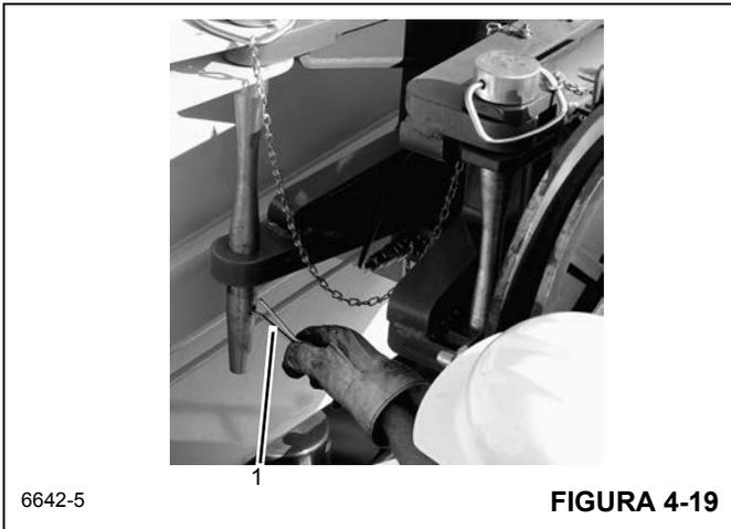
11. Usando o cabo de apoio, gire a extensão até a posição e alinhe os olhais na extensão (1) (Figura 4-22) aos furos nos olhais na extremidade da lança (2).
