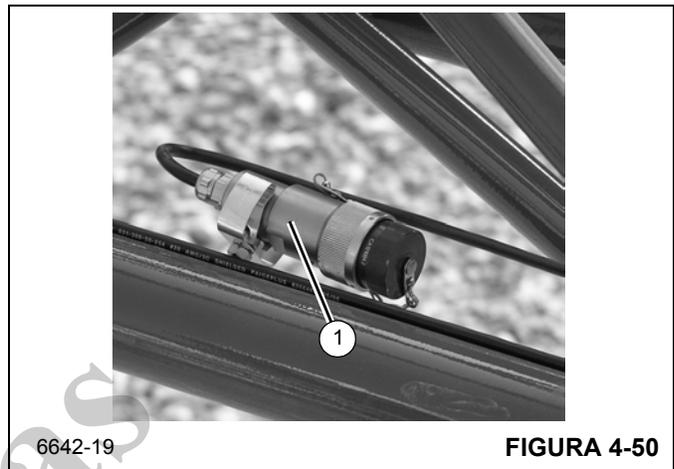
**NOTA:** Se o guindaste estiver equipado com uma extensão de lança oscilante hidráulica, desconecte os acoplamentos hidráulicos entre a extensão e a lança principal. Consulte Conexão e desconexão da extensão da lança hidráulica nesta seção.
