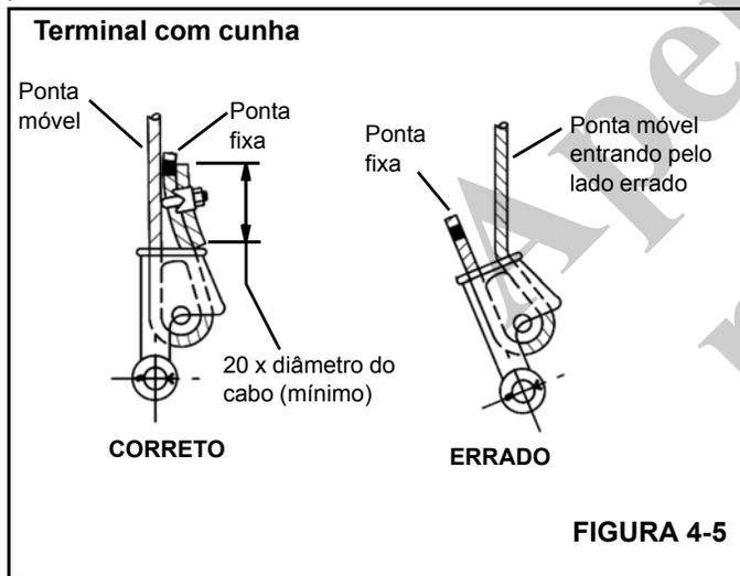
4. Insira a extremidade do cabo de aço no terminal, forme um laço no cabo e passe-o de volta através do terminal deixando que a ponta fixa (Figura 4-5) sobressaia do terminal. Verifique se a ponta fixa do cabo tem comprimento suficiente para que seja possível aplicar o tratamento da extremidade à ponta fixa após a cunha ter sido assentada.
