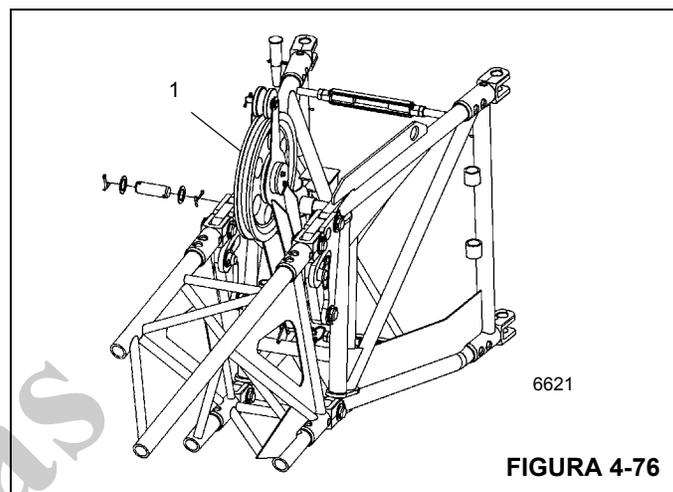
Para evitar que o cabo de elevação se arraste na lança principal ou na extensão da treliça durante a operação com a extensão da treliça ou a extensão da lança, o cabo de elevação é guiado através de polias defletoras.
