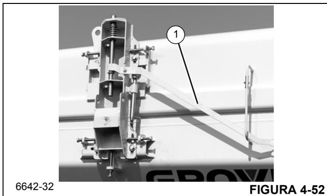
6. Puxe o pino de trava dianteiro (1) (Figura 4-53), gire a rampa de armazenamento para fora e trave na posição desdobrada.
