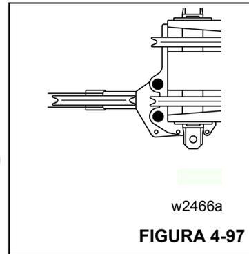
No lado esquerdo da cabeça lança principal há um dispositivo de retenção. Na posição de trabalho, a extremidade da lança auxiliar de polia única é conectada à cabeça da lança principal nos dois furos (Figura 4-97).
