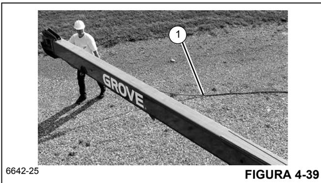
**NOTA:** Não abaixe a lança até que as duas seções estejam completamente giradas na frente da seção de 33 pés (10,1 m).
