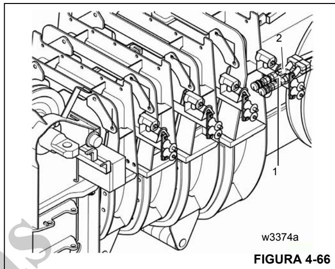
Pode-se liberar o dispositivo antitorção somente após ter fixado o alívio de tensão (1) de volta no suporte (2) na lança principal.
