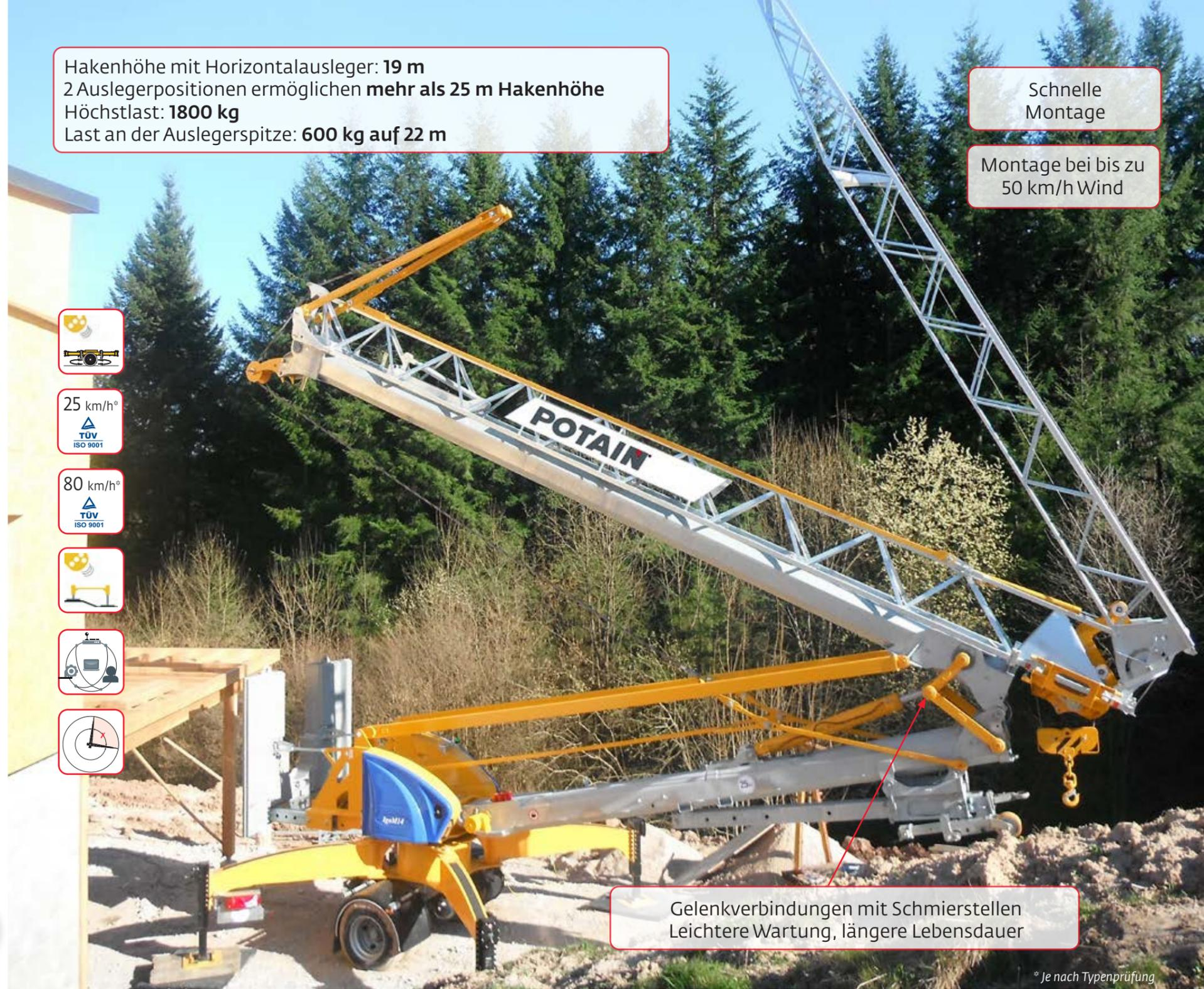
Gelenkverbindungen mit Schmierstellen
