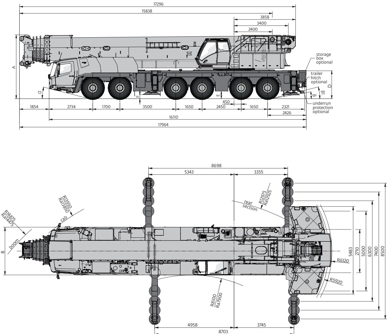
*Ra = Radius all wheels steered. • Radius allradgelenkt. • Rayon toutes les roues directrices. • Radio de giro con todas las ruedas giradas. • Raggio di curva con tutte le ruote sterzate. • Paðuyc novopoma npu управлении всеми колесами.*
