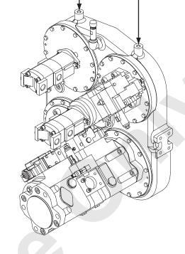
LIFTING SCREW HOLE (M16)
