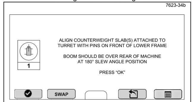
Gire a torre com contrapeso montado até que o contrapeso se alinhe aos pinos de retração na estrutura inferior, e em seguida, selecione OK na tela de calibração do sensor de giro.
