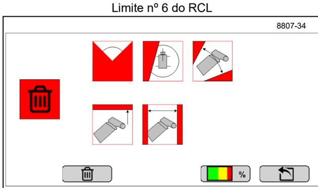
A tela de limite nº 6 do RCL permite que o operador exclua todos os valores existentes de limite.
