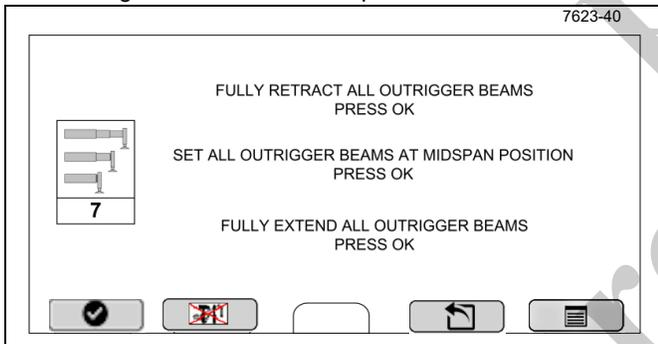
São indicadas três posições de calibragem na tela de calibragem do sensor de comprimento do estabilizador, uma de cada vez, começando da posição totalmente retraída.
