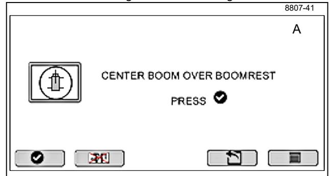
Posicione a lança na linha de centro do caminhão, no suporte da lança, e selecione OK na tela de calibração do sensor de giro.
