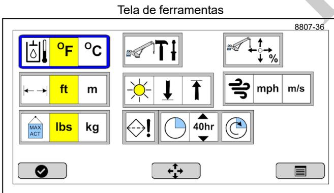
A tela de ferramentas contém: configuração, calibração, ferramentas e informações de medições no mostrador.
