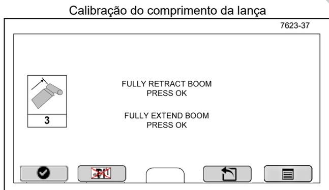
São indicadas duas posições de calibração, uma de cada vez, começando da posição totalmente retraída, na tela de calibração do comprimento da lança.
