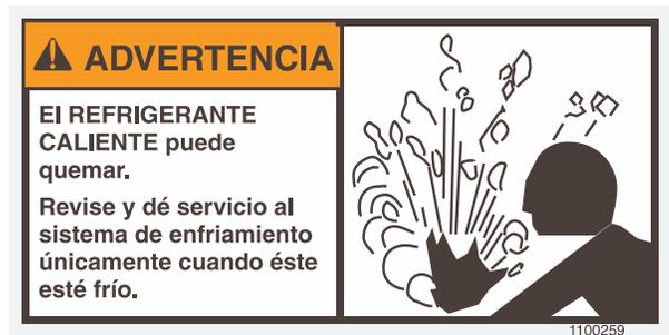
**NUNCA** retire la tapa del radiador mientras el sistema de enfriamiento está caliente. Revise el nivel de refrigerante únicamente cuando la temperatura del refrigerante esté bajo 50°C (120°F). El sistema está bajo presión y el refrigerante puede ocasionar quemaduras graves o lesiones en los ojos. Use vestimenta protectora y gafas de seguridad. Siempre gire la tapa lentamente al primer tope y deje que la presión se escape antes de retirar la tapa completamente.
