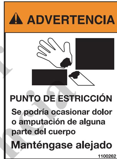
Los engranajes giratorios pueden causar lesiones. Mantenga las manos alejadas del piñón y engranaje giratorios mientras el mástil se encuentra girando. Arranque el motor y gire el mástil hasta que el punto alto de la corona de giro esté alineado con el piñón. El punto alto se encuentra marcado con punzón en la placa del mástil (Figura 5-34).
