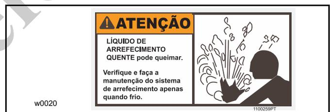
**Nunca** remova a tampa do radiador enquanto o sistema de arrefecimento estiver quente. Verifique o nível do líquido de arrefecimento só quando o líquido de arrefecimento estiver frio. O sistema está pressurizado e o fluido de arrefecimento pode causar graves queimaduras ou lesões nos olhos. Use óculos e roupas de segurança. Sempre gire a tampa lentamente até a primeira parada e deixe a pressão escapar antes de remover a tampa completamente.
