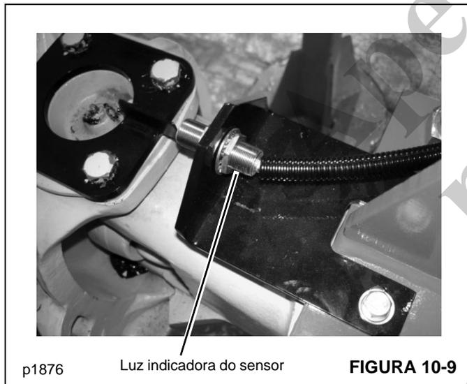
4. Se o sensor estiver funcionando corretamente, verifique o espaçamento entre o sensor e o suporte do sensor. Ajuste se necessário.
