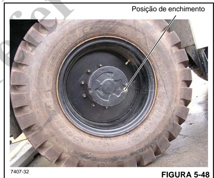
4. Abasteça o cubo da roda com aproximadamente 2,0 l (2.1 qt) de Mobil Fluid 424 através do furo exposto até o óleo alcançar o fundo do furo.
