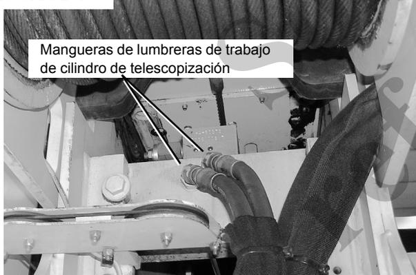
1. Retire las mangueras de extensión y de retracción (lumbreras de trabajo) del cilindro de telescopización (Figura 2-4). Tapone las lumbreras de telescopización del cilindro y las mangueras.
