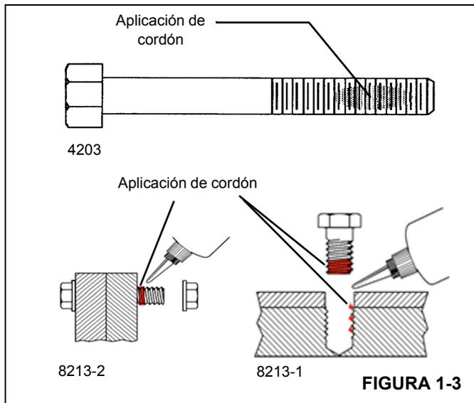
1. Aplique un cordón en sentido perpendicular a las roscas, de un ancho equivalente al de varias roscas, en la zona aproximada de engrane de las roscas (vea la Figura 1-1).
