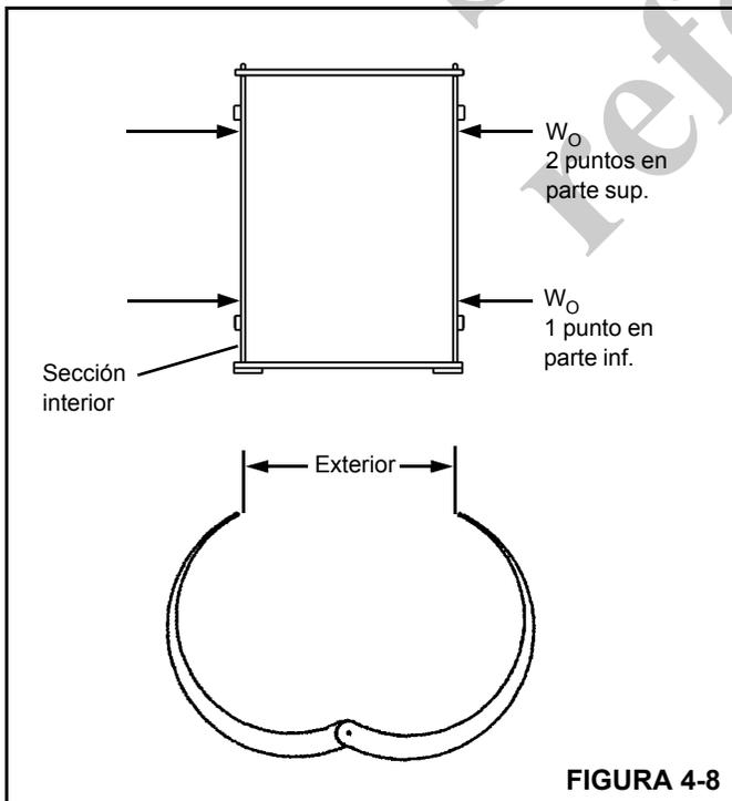
2. Utilice el compás de espesores interiores/exteriores para medir el ancho exterior de la sección interior ( $W_0$ ) en la posición de cada almohadilla lateral. Anote la medida más grande.
