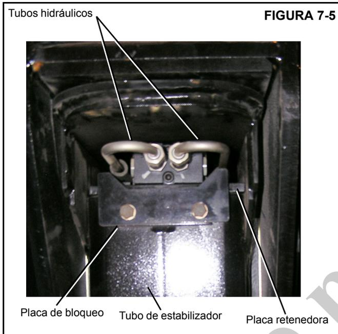
23. Saque los pernos y la placa de bloqueo del tubo del estabilizador.
