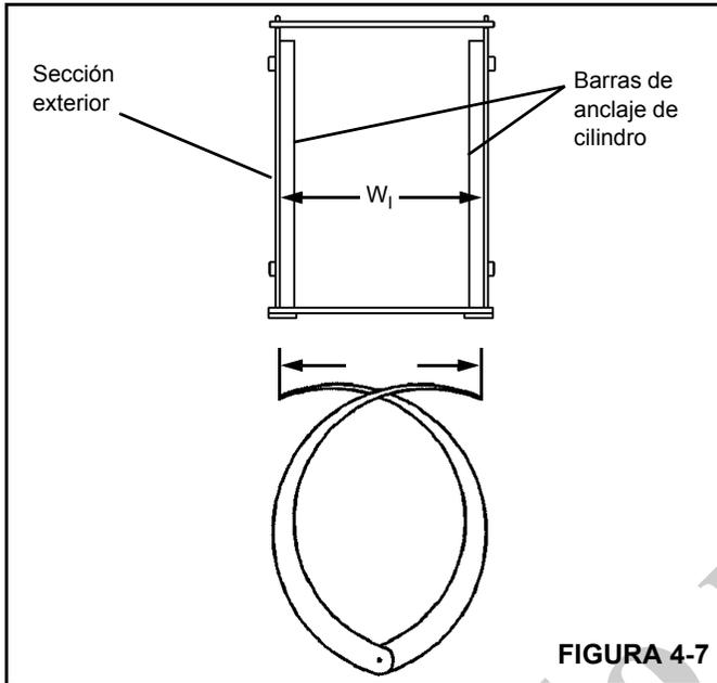
1. Con un compás de espesores interiores/exteriores, mida el ancho interior de la sección exterior ( $W_1$ ) en las partes delantera y trasera de la pluma y anote la medida más pequeña. Si la sección dispone de barras de anclaje de cilindro, efectúe la medición directamente delante de estas barras.
