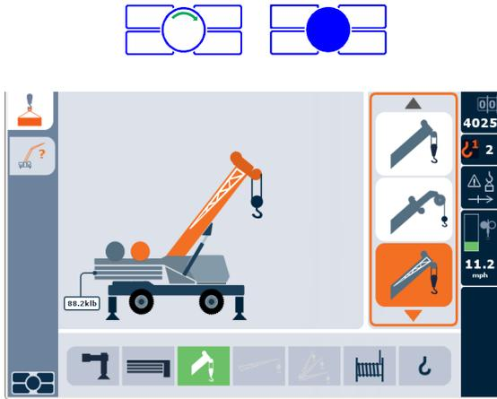
**Ajuste o ângulo do jib (se instalado).**
