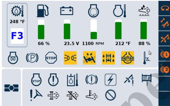
Quando um dos ícones na barra vertical do lado direito pisca, ele indica que o joystick não estava na posição zero quando o botão de ativação de função ou o botão de todas as funções do guindaste foram pressionados. Para ativar a função, o operador deve mover o joystick para a posição central/sem movimentação, e então tentar ativar a função novamente.
