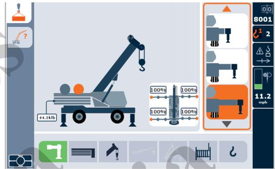
O RCL está funcionando corretamente se nenhuma mensagem de erro é exibida. Se for apresentado algum código de falha, o indicador de falha na tela principal do CCS será iluminada em vermelho.
