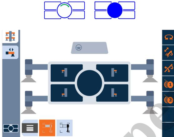
O operador pode escolher qual feixe, ou combinação de feixes, deverá ser estendido ou retraído. Pressione a parte superior da chave de ativação da função de estabilizador no apoio de braço esquerdo para selecionar a extensão do estabilizador.
