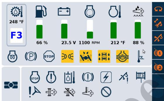
Quando um dos ícones na barra vertical do lado direito pisca, ele indica que o joystick não estava na posição zero quando o botão de ativação de função ou o botão de todas as funções do guindaste foram pressionados. Para ativar a função, o operador deve mover o joystick para a posição central/sem movimentação, e então tentar ativar a função novamente.
