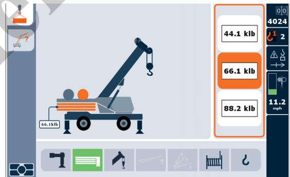
**NOTA:** Quando o ícone de substituição do RCL (acima, o terceiro ícone a partir de cima na barra do indicador de status da direita) está piscando, isso significa que a chave de substituição estava ativa na hora da iniciação do guindaste. Neste caso, a substituição NÃO está ativada. Para substituir o RCL, gire a chave para a posição DESLIGADO por um segundo. Então, a substituição pode ser mudada para LIGADO novamente, e o RCL será contornado.
