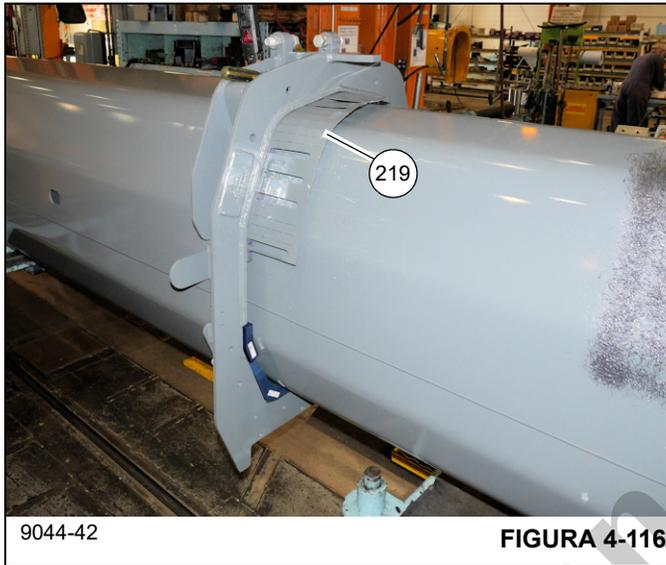
**77.** Solte completamente o parafuso de ajuste da placa de desgaste central direita (244) e depois aperte completamente o parafuso de ajuste da placa de desgaste central esquerda (244). Instale o calço (219) na parte superior das placas de desgaste laterais esquerdas batendo levemente com uma marreta de borracha ou bloco de madeira. Solte completamente o parafuso de ajuste da placa de desgaste central do lado esquerdo (244).
