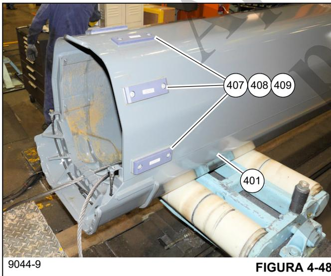
66. Remova as duas porcas (8) e arruela (9) de cada um dos dois cabos de retração (7) na parte dianteira do telescópio 3 (401) (consulte a Figura 4-49). Remova os
