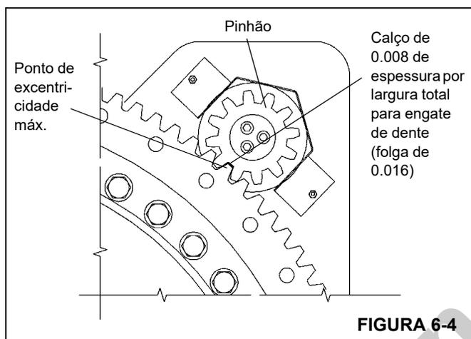
5. Instale o pinhão da caixa de engrenagens alinhando o ponto superior (excentricidade máxima) ao rolamento da plataforma rotativa. Usando um calço de 0,203 mm (0.008 pol.) de espessura, verifique a folga (Figura 6-4). Se for necessário movimentar o pinhão para obter a folga adequada, entre em contato com o distribuidor local.
