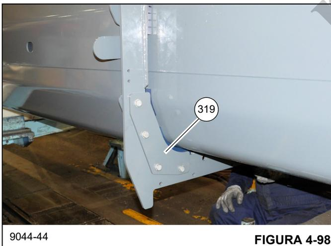
49. Insira o telescópio 3 (401) no telescópio 2 (301) até que os laços (H) nos dois cabos de retração (7) estejam a aproximadamente 1-1/2 pé de distância da parte traseira do telescópio 2 (301). Certifique-se de que os cilindros telescópicos (501, 502) estejam centralizados e de que não batam no telescópio 2 (301) ao passar através dele (consulte a Figura 4-99).
