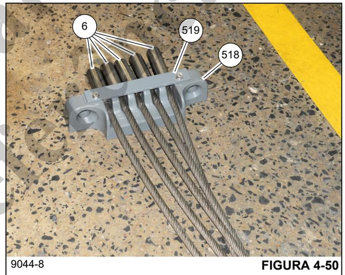
68. Remova os dois parafusos, arruelas e arruelas de pressão (530, 531, 538) que fixam a placa de fixação do
