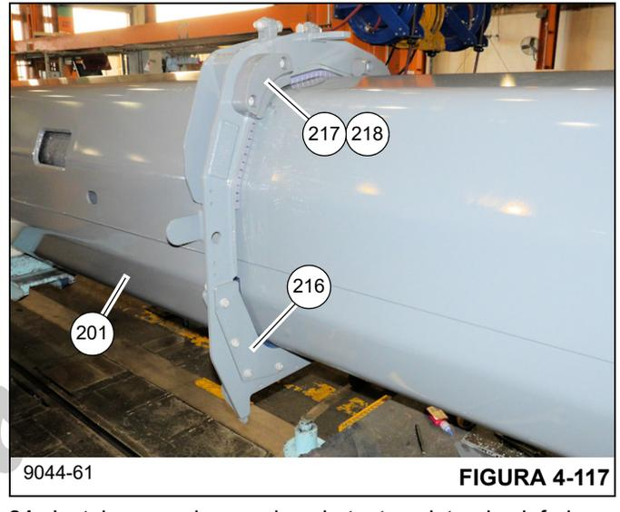
**81.** Instale as placas dos batentes laterais inferiores esquerda e direita (conforme orientadas) (216) na parte dianteira do telescópio 1 (201) usando os parafusos, arruelas, arruelas de pressão e porcas (238, 235, 236, 247) (consulte a Figura 4-117).
