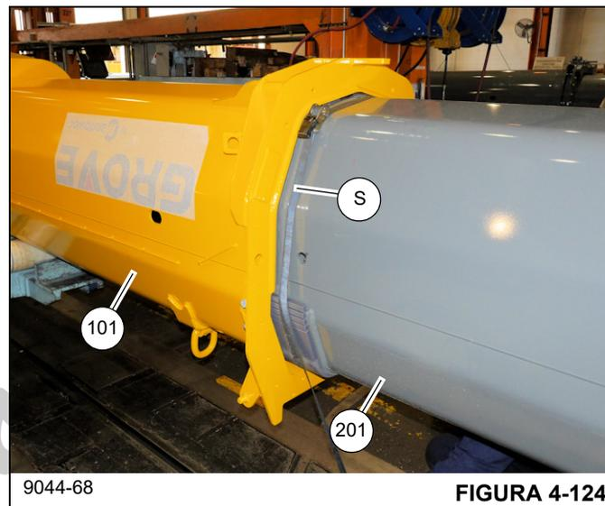
95. Insira o telescópio 1 (201) na base (101) até que todas as placas de desgaste na traseira do telescópio 1 (201) estejam dentro da base (101).
