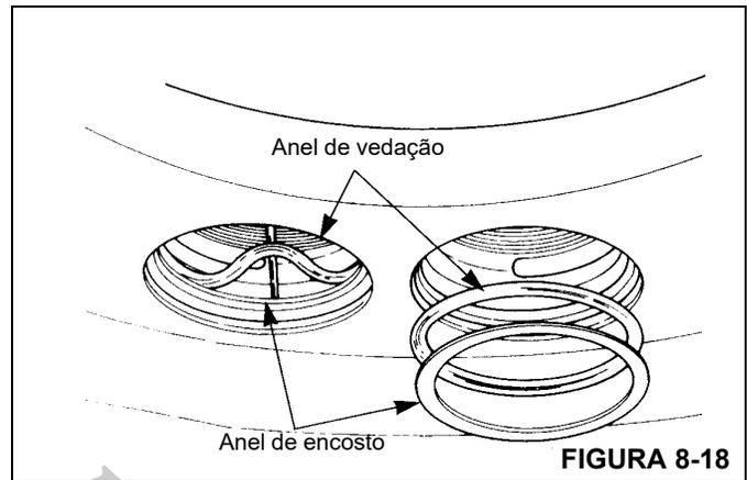
11. Inspeção se há a arranhões e ferrugem nos canais do anel na carcaça. Remova os pequenos arranhões e a ferrugem com uma lixa. Substitua a carcaça se os arranhões forem grandes ou se houver muita ferrugem. Consulte *Peças do calíper*, página 8-19 nesta seção.
