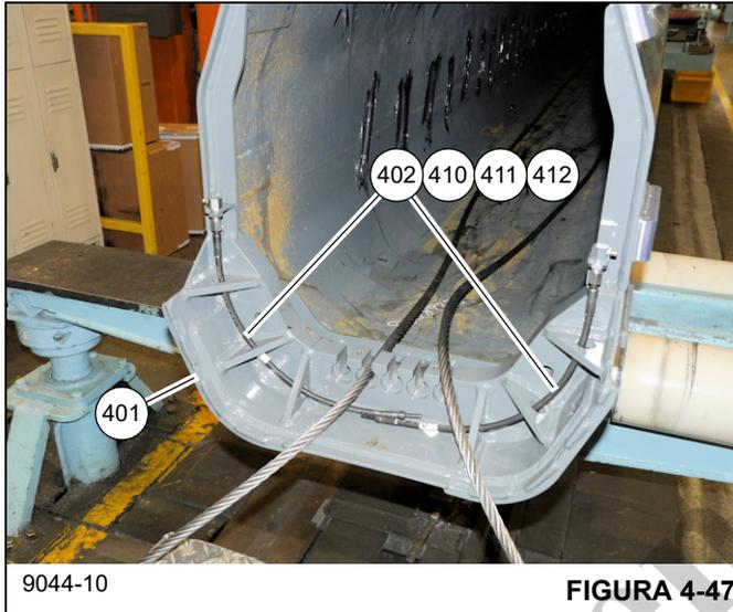
65. Remova os dois parafusos (414) de cada uma das seis placas de desgaste (407) e calços (408, 409) na traseira do telescópio 3 (401) (consulte a Figura 4-48).
