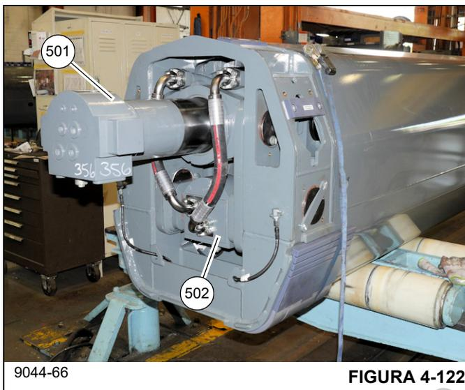
93. Aplique antiengripante nos dois olhais dos munhões do cilindro telescópico nº 2 (501) e instale as placas (513) nos lados esquerdo e direito (consulte a Figura 4-123).
