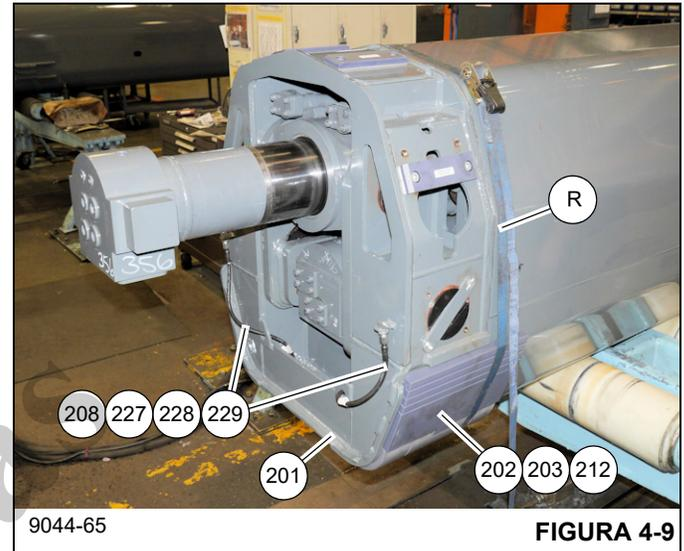
16. Remova a mangueira de graxa (208) e as conexões (227, 228, 229) da traseira do telescópio 1 (201) (consulte a Figura 4-9).
