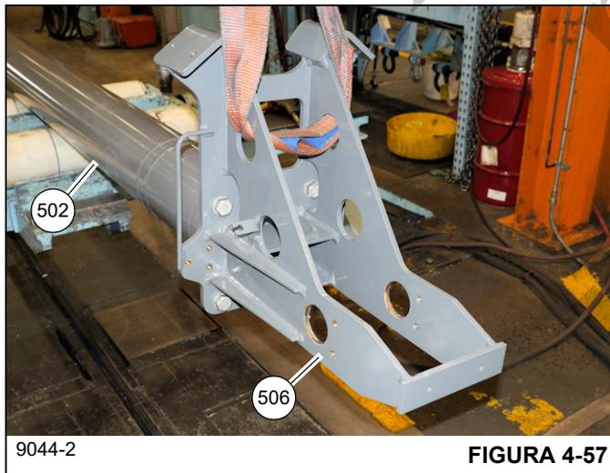
3. Instale a polia da cabeça do cilindro (509) no conjunto soldado da cabeça da polia (506) e fixe com o pino da polia (516). Instale uma placa (522) usando dois parafusos e arruelas de pressão (535, 540) em cada lado do
