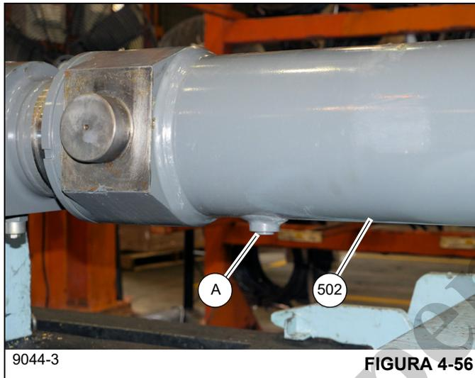
2. Instale o conjunto soldado da cabeça da polia (506) na parte dianteira do cilindro telescópico nº 1 (502) usando quatro parafusos e arruelas (542, 529) (consulte a Figura 4-57).
